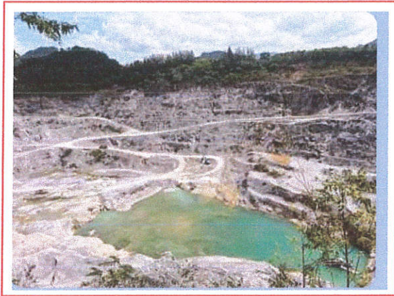
รูปที่ 1 พัฒนาเหมืองเป็นแบบขั้นบันได
