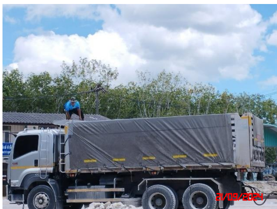
รูปที่ 14 การปิดคลุมกระบะรถบรรทุกและป้ายเตือน
